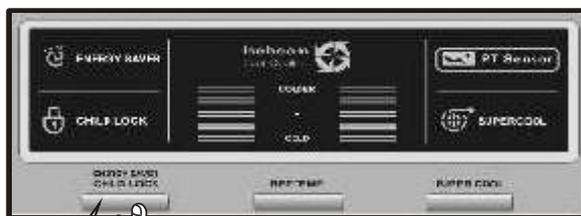
Si vous appuyez encore une fois sur la même clé pour 5 seconds, toutes les fonctions du réfrigérateur ou tous les paramètres seront verrouillés. L'icône de l'activation sera éteint et les paramètres seront sujets à changer.
