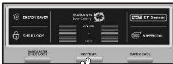
Pour économiser l'électricité, réglez le LED pour la position de "Froid". Quand le bouton de Super Refroidissement est pressé, le réfrigérateur va au mode Super Refroidissement et l'icône de super refroidissement sera allumée. Cette fonction vous permet d'être
