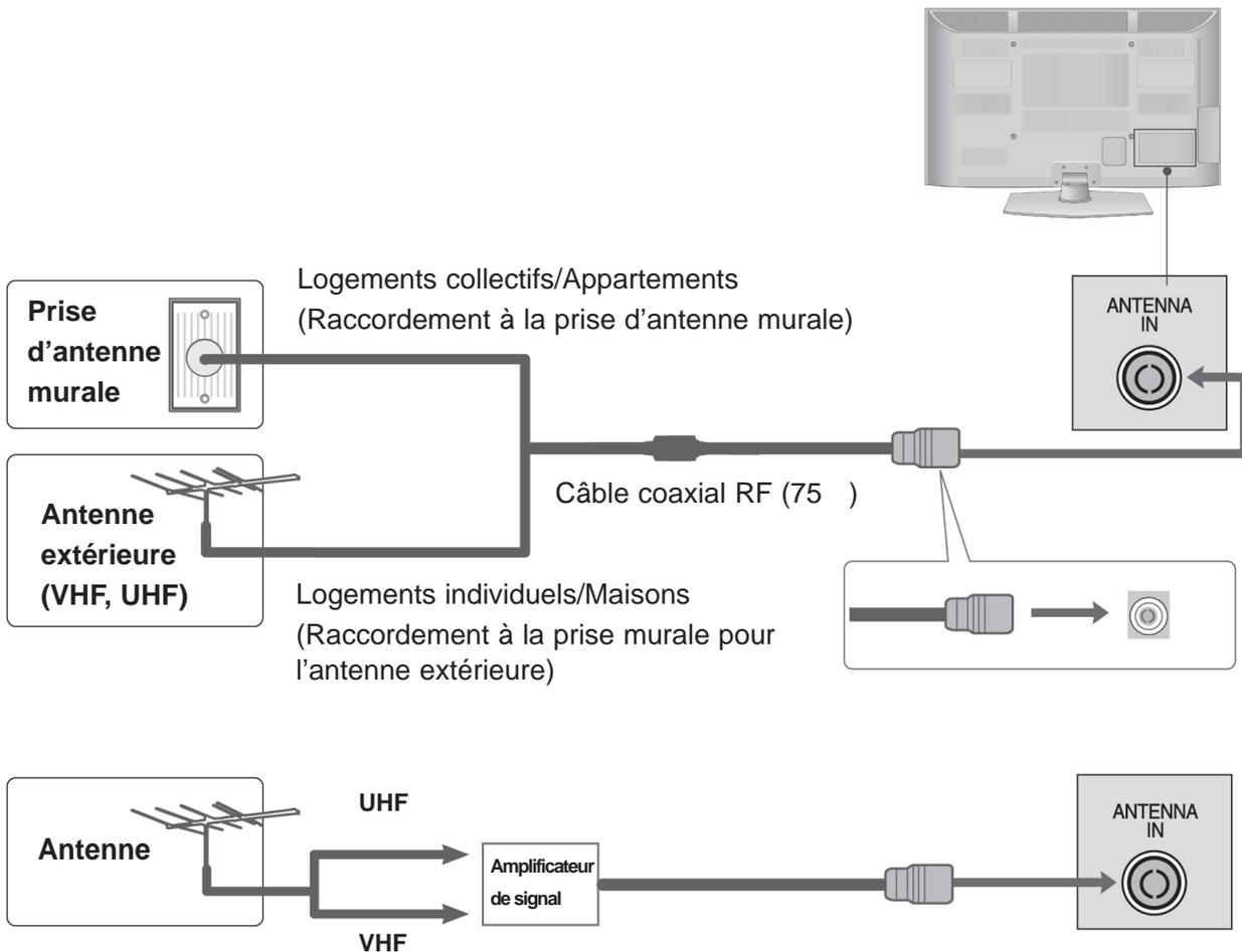
Pour recevoir une image de meilleure qualité dans les zones où le signal est faible, installez un amplificateur de signal sur l'antenne comme indiqué ci-dessus.
