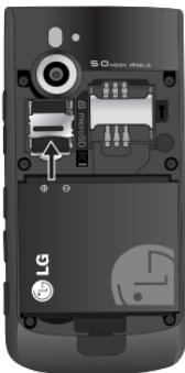
打开卡扣，如上图所示，将外置内存卡放入卡槽对正后往下推卡扣。
