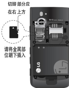
将卡扣往上推，打开卡扣后，取出外置内存卡。
