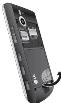
将电池两侧和手机侧槽对正后往下按，直到听见“咔嚓”的响声。
