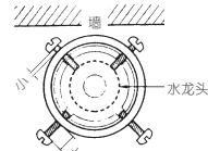
4 将上连接座抵住水龙头口，使其内部密封垫与水龙头充分接触(请注意不可取出密封垫)。
