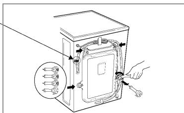
1. 为了防止运输途中的内部损坏,安装了4个螺栓,在使用洗衣机前沿着运输螺栓橡胶拆除这些螺栓。
