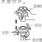
2 将进水管连接头直接套在水龙头上进行安装。
