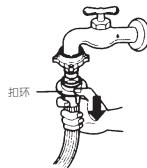
5 如图旋转墙对侧的两个螺钉使其与水龙头接触后，再用螺丝刀旋紧。
