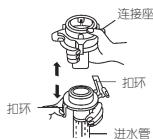
2 将上连接头上的四颗固定螺钉拧松，旋转下连接头，使上下连接头间有足够的距离(3个螺纹的高度)进行螺钉安装。
