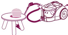
集尘筒集满时，请您正确开启集尘筒清理。请您注意不要在没安装集尘筒或过滤网时使用吸尘器。
