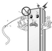
电器部位应该避免浸水，如浸水请立即切断电源并与维修人员联系。
