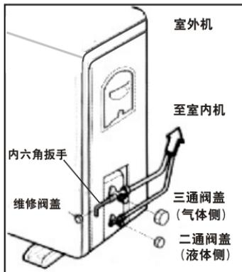
\* 产品出厂时室外机已充入用于排空气所消耗的制冷剂。
