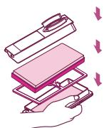
① 将电机保护过滤器装入过滤器外壳内。
