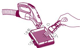
1 使用其他吸尘器或集尘盒上的毛刷对 HEPA 过滤器以及内部间隙进行清理
