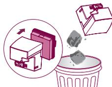
**2** 握住集尘盒两端，取出过滤器（海绵过滤器和HEPA过滤器），清空集尘盒内的灰尘。倾倒灰尘时请小心打开过滤器，防止灰尘飞溅
