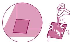
2 用清水将海绵过滤器进行清洗，放置于通风良好的避光处充分晾干后，再使用。
