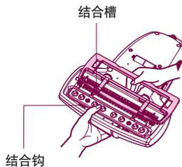
2 将清扫毛刷支架的结合槽与主机结合钩组装在一起。用一字起子或类似工具将两个固定锁扣逆时针旋转90°后，组装完毕。
