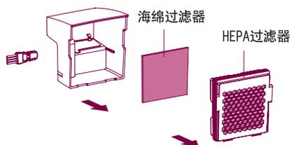
如上图所示，将过滤器从集尘盒中分离出来后，再将海绵过滤器从 HEPA 过滤器中分离出来。
