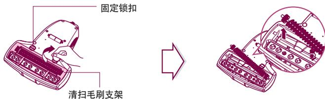
在地板上放置一块软布，将吸尘器主体翻转后放在上面。检查是否有异物，然后用一字起子或类似工具沿顺时针方向将两个固定锁扣旋转90°后，取下清扫毛刷支架。握住毛刷，将其取出。
