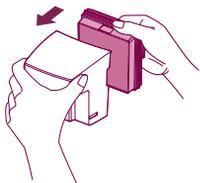
**5** 将过滤器（海绵过滤器和HEPA过滤器）插入集尘盒
