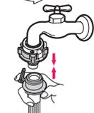
将进水管向上插入下连接座，保证扣环位于下连接座卡槽内。
