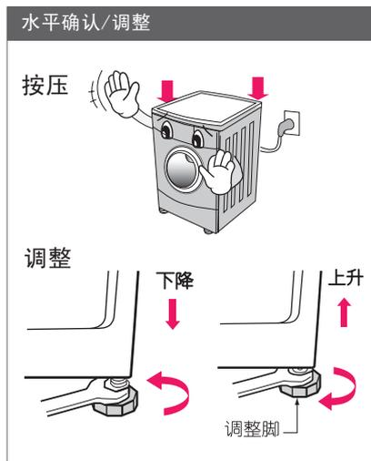
安装时分别按压洗衣机顶部对角线，如有晃动请调整底部调整脚至水平；在保证水平的情况下，底脚尽可能调低，并锁紧防松螺母以免振动噪音过大。
