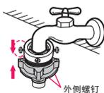
将上连接座抵住水龙头使其内部密封垫与水龙头充分接触。同时旋转外侧的两颗螺钉使其与水龙头接触后再用螺丝刀拧紧
