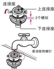
旋转上下连接座，使接头间有3个螺纹的间隙后，拧松上连接座上的四颗螺钉。
