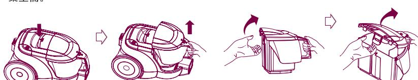
▶ 倾倒出集尘桶里面的灰尘后，用冷水清洗集尘桶，打开桶盖放置在阴凉处风干。扣好集尘桶盖后，如箭头所示方向装入机体。
