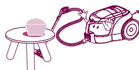
注意不要使电源线夹在门缝里或用电源线提拉吸尘器，防止电源线受损。
