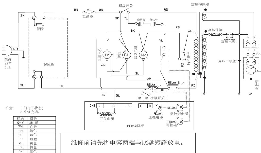
注：F.M=风扇电机 T.T.M=转盘电机 O.L=炉灯 Relay=继电器
