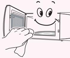
使用后必须等微晶玻璃冷却后再进行清洁，并且注意不能使用尖锐物进行清洁，以免损坏硅胶。
