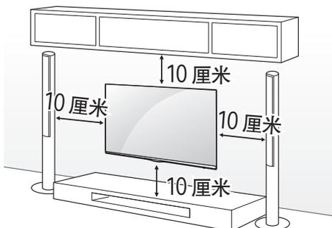
确保使用符合 VESA 标准的螺钉和挂架。下表中介绍了壁挂套件的标准尺寸。
