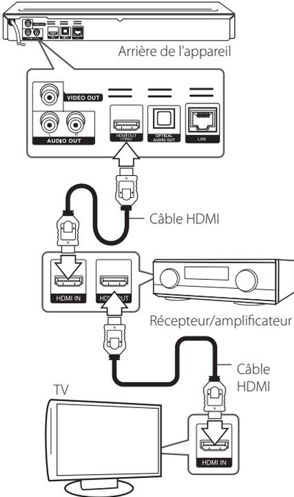
Raccordez la prise de sortie HDMI de l'amplificateur à la prise d'entrée HDMI de votre téléviseur à l'aide d'un câble HDMI si votre amplificateur possède une prise de sortie HDMI.
