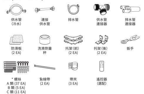
\* A 類:長金屬板螺絲; B 類:短金屬板螺絲; C 類:機械螺絲
