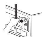
**3** 使用鉗子調整帶夾,以固定軟管,防止泄漏。
