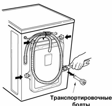
1. Отвинтите 4 болта при помощи гаечного ключа, который входит в комплект поставки машины.
