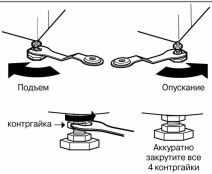
2. Если пол неровный, обеспечьте горизонтальное положение стиральной машины при помощи регулируемой ножки. (Не следует для выравнивания положения подкладывать под ножки куски древесины и т.п.) Убедитесь, что все четыре ножки твердо стоят на полу, а затем проверьте горизонтальное положение стиральной машины (при помощи спиртового уровня).
