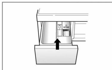
4. Вставьте выдвижной ящик в отсек и задвиньте его до упора. После окончания чистки включите стиральную машину в режиме полоскания.
