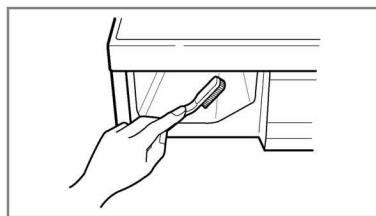
3. При помощи щетки очистите отсек для выдвижного ящика.
