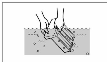
2. Тщательно промойте его в проточной воде.
