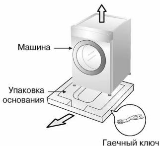
1. Удалите картонную коробку и пенопласт.
