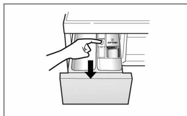
1. Нажав на стопорную защелку, извлеките выдвижной ящик из стиральной машины.
