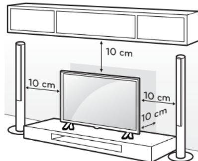
Instalação do aparelho em uma mesa (meramente ilustrativa).
