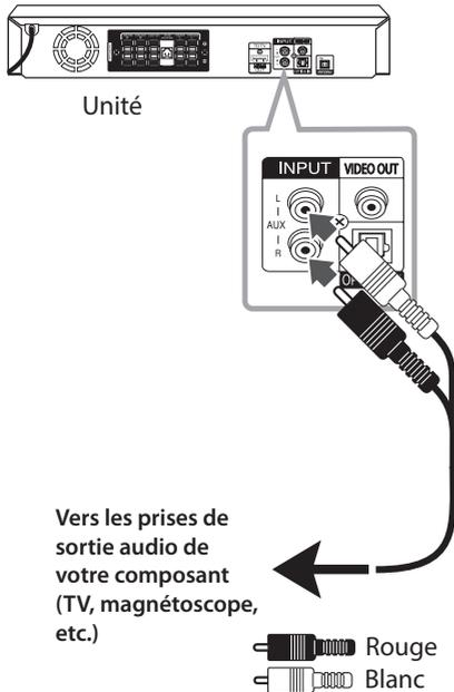
Vers les prises de sortie audio de votre composant (TV, magnétoscope, etc.)
