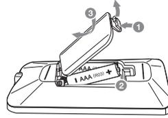
Retirez le couvercle situé à l'arrière de la télécommande et insérez la pile avec + et - correctement placés.
