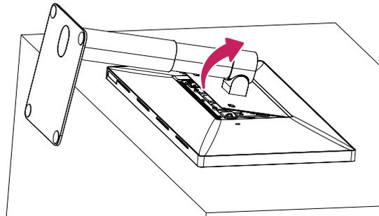
4 将处于旋转位置的支架从显示器上拆下。
