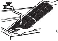
يجب فحص وتنظيف فلتر الهواء الموجودة خلف اللوحة الأمامية / الشبكة مرة كل أسبوعين أو أكثر عند الضرورة. لإزالة الفلتر، راجع الأشكال البيانية الواضحة الخاصة بكل طراز. قم بتنظيف الفلاتر باستخدام المكنسة الكهربائية أو قم بغسلها بالماء الدافئ والصابون. إذا لم يكن من السهل التخلص من الأوساخ، اغسل الفلتر باستخدام منظف في ماء فاتر. جففه جيداً في الظل بعد الغسل بالماء ثم أعد تركيبه في موضعه.
