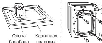
Снимите транспортировочные болты и опоры.
