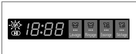
Verrouillage de la porte : pour des raisons de sécurité, la porte sera verrouillée pendant le fonctionnement du lave-linge et l'icône correspondante sera allumée. Une fois l'icône de verrouillage de la porte éteinte, vous pouvez ouvrir la porte en toute sécurité.
