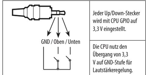
Jeder Up/Down-Stecker wird mit CPU GPIO auf 3,3 V eingestellt.
