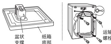
拆除运输螺栓和盆状支撑。
