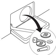
4 清理后，转动泵过滤器并插入排水塞。
