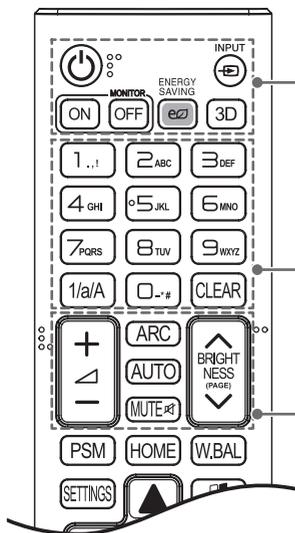
**⏻ (ENCENDIDO/APAGADO)** Permite encender y apagar el monitor.
