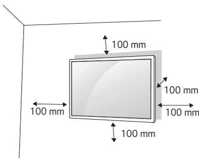
Si instala el monitor en una pared, fije un soporte de montaje en pared (pieza opcional) a la parte trasera del monitor. Asegúrese de que el soporte de montaje en pared esté bien fijado al monitor y a la pared.
