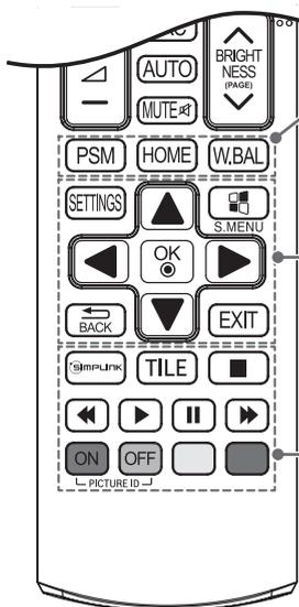
**PSM** Permite seleccionar Picture Mode (Modo de imagen).
