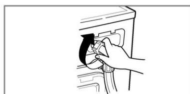
4. Під'єднайте та закріпіть водозабірний шланг.
