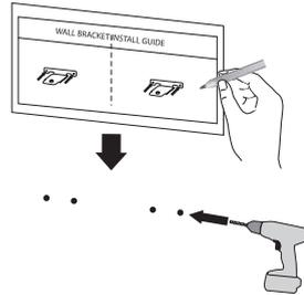
3. Retire la guía de instalación del soporte de pared.
