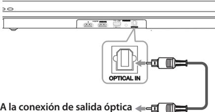
A la conexión de salida óptica del dispositivo externo
