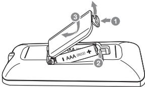
Retire la cubierta de las baterías en la parte posterior del control remoto e introduzca dos baterías R03 (tamaño AAA) de 1,5 Vcc con el símbolo **+** y **-** en posición correcta.
