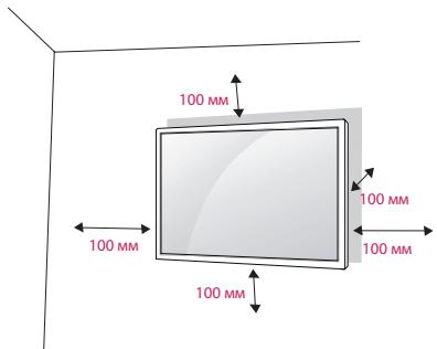
Чтобы установить монитор на стену, прикрепите кронштейн для настенного крепления (дополнительная деталь) к задней части монитора. При установке монитора с помощью кронштейна для настенного крепления надежно закрепите кронштейн, чтобы предотвратить падение монитора.
