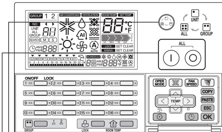
1 Seleccione el modo de control "ALL" (Todo) pulsando el botón del control AC Ez maestro. El control AC Ez maestro indica el icono en el LCD.
