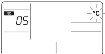
Al acceder al modo de cambio Centígrados/Fahrenheit, se muestra '05' y parpadea '°C' o '°F' en el LCD.
