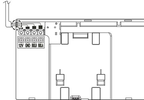
Realice la fijación con el tornillo facilitado en la parte inferior tras colocarlo en el soporte.
