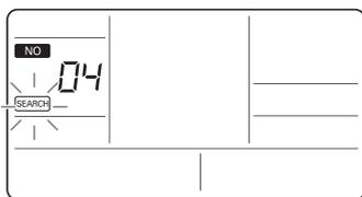
3 Tras pulsar el botón **OK**, se inicia la búsqueda de la unidad interior conectada. El led on/off individual parpadea por rotación y **SEARCH** del LCD parpadea.
