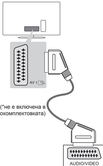
Предава видео и аудио сигнали от външно устройство на телевизора. Свържете външно устройство с телевизора чрез Euro Scart кабел, както е показано на следната фигура.
