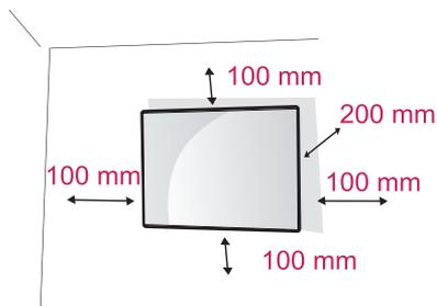
请适用符合 VESA 标准的螺钉和壁挂表面。
