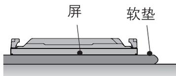
将产品放下时，在平的地面上放一个软垫。将产品面板朝下放置。
