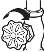
9 BRANCHER LE TUYAU AU RÉFRIGÉRATEUR
