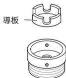
3 將接頭推入水龍頭末端，使橡膠密封件形成防水連接。緊固四個固定螺絲。
