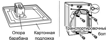
Снимите транспортировочные болты и опоры.
