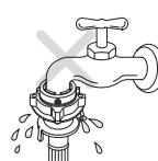
Nếu chỗ nối bị rò rỉ, đóng vòi lại và bắt đầu lại từ bước 1.
