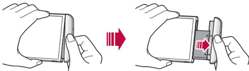
3 Sostenga la batería y el módulo con las dos manos y sepárelos como indica la imagen para desconectar las terminales de la batería.
