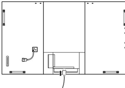
2 Monte el altavoz por medio los tornillos, tal y como se muestra a continuación. Asegúrese de desconectar el cable de alimentación antes de realizar ninguna conexión.
