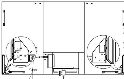
3 Conecte los terminales de los altavoces respetando la polaridad correcta. Una vez instalados los altavoces, utilice los organizadores de cables y sujetacables para organizar los cables de los altavoces.
