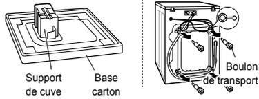
Enlever les boulons de transport et le support de cuve.
