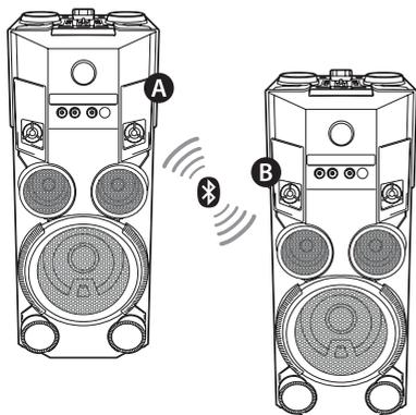
1. Pritisnite i zadržite 3 sekunde dugme **F / WIRELESS LINK** na uređaju. Na displeju će se prikazati PARTY LINK MODE SELECT.
