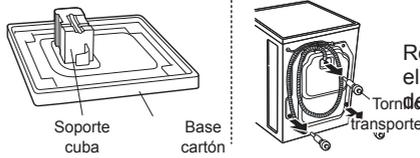
Retire los tornillos para el transporte y el soporte de la cuba.
