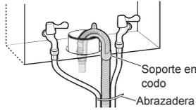
Reinstale el tubo de desagüe.
