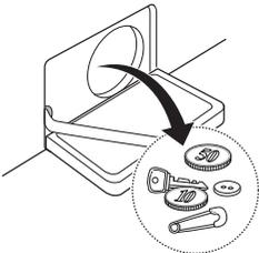
4 Después de limpiar, gire el filtro de la bomba y coloque el tapón de desagüe.
