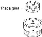
3 Empuje el adaptador sobre el extremo del grifo para que la junta de goma forme una conexión estanca. Apriete los cuatro tornillos de fijación.
