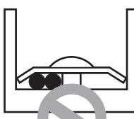
Il est interdit de connecter des câbles d'épaisseurs différentes.
