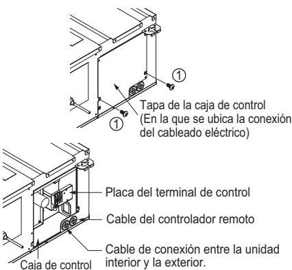
**Conduit dissimulé dans le plafond – statique basse, statique médiane**
