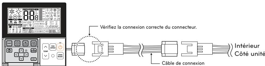
**Utilisez un câble d'extension si la distance comprise entre la commande à distance câblée et l'unité intérieure est supérieure à 10 m.**
