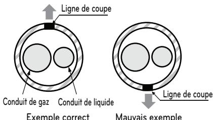
\* La ligne de coupe du tube doit être orientée vers le haut.
