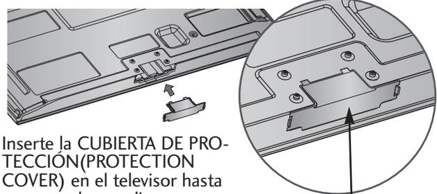
Inserte la CUBIERTA DE PROTECCIÓN (PROTECTION COVER) en el televisor hasta que escuche un clic.
