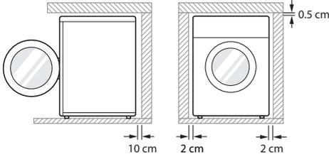
**Lantai yang rata** : Kemiringan yang diizinkan di bawah keseluruhan peralatan adalah  $1^\circ$ .
