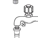
水龙头上螺纹尺寸过大(例: 六分螺纹G3/4), 与螺纹式连接头不匹配, 这种情况不安装
