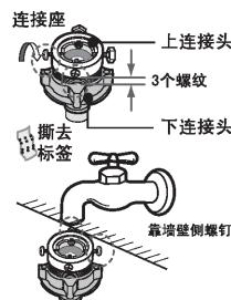
旋转上下连接头, 使接头间有3个螺纹的间隙后, 拧松上连接头上的四颗螺钉。
