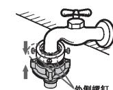
将上连接头抵住水龙头使其内部密封垫与水龙头充分接触。同时旋转外侧的两颗螺钉使其与水龙头接触后再用螺丝刀拧紧。
