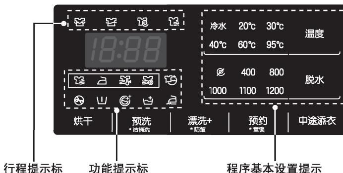
**行程提示标:** 提示洗衣机当前运行的阶段。运行时，对应的行程提示标闪烁；还未进行的行程，提示标保持灯亮；已完成的行程，提示标灭。
