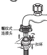
一边按住扣环, 一边将进水管向上插入连接头
