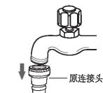
将原连接头从水龙头上旋下拆除
