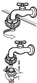
旋转下连接头直到上下连接头拧紧为止。（如未拧紧，会发生漏水）
