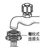
将螺纹式连接头旋上并拧紧, 如果未拧紧, 会造成漏水
