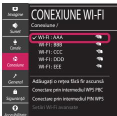
Pentru punctul de acces fără fir (router) care are simbolul
