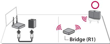
1. Adhiera el cable de alimentación al puerto de suministro en la parte trasera del **Bridge (R1)** y conecte el enchufe a una toma de corriente.
