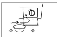
3. Выньте все посторонние предметы из фильтра (③). После чистки поверните фильтр (③) по часовой стрелке и вставьте на место дренажную пробку (②). Закройте дверцу на нижней панели.
