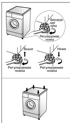
1. Для предотвращения вибрации и чрезмерного шума необходимо придать стиральной машине строго горизонтальное положение. Стиральную машину следует устанавливать на твердом, ровном полу, желательно в углу комнаты.
