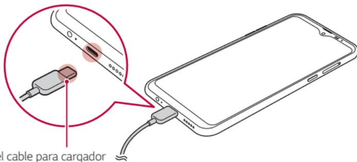
Terminal del cable para cargador
