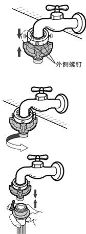
将上接头抵住水龙头使其内部密封垫与水龙头充分接触。同时旋转外侧的两颗螺钉使其与水龙头接触后再用螺丝刀拧紧
