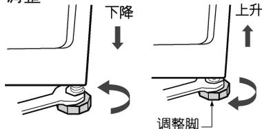
安装时分别按压洗衣机顶部对角线，如有晃动请调整底部调整脚至水平；
