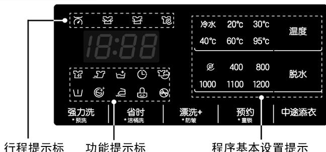
**行程提示标：**提示洗衣机当前运行的阶段。运行时，对应的行程提示标闪烁；还未进行的行程，提示标保持灯亮；已完成的行程，提示标灯灭。
