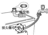
• 确保与进水阀连接的接头内有橡胶垫,并拧紧接头螺母后通水试机
