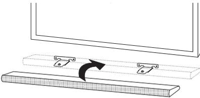
6. Fixez fermement l'appareil avec les vis.
