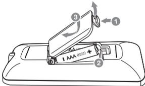
Enlevez le couvercle du compartiment à piles à l'arrière de la télécommande, et insérez deux piles AAA en respectant la correspondance entre **+** et **-**.
