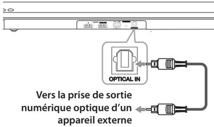
1. Connectez la prise OPTICAL IN derrière l'appareil à la prise de sortie optique de votre téléviseur (ou appareil numérique).
